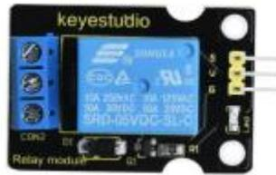
Este módulo es un módulo dedicado Arduino y es compatible con la placa de expansión del sensor Arduino. Tiene un sistema de control (también llamado bucle de entrada) y un sistema controlado (también llamado bucle de salida). Comúnmente utilizado en circuitos de control automático, el módulo de relé en un “interruptor automático” que controla una corriente más grande y un voltaje más bajo con una corriente más pequeña y un voltaje más bajo.
