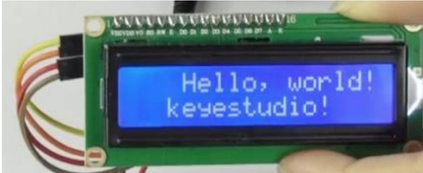
Nota. Cablee de acuerdo con el diagrama de conexión, cargue el código y después del encendido, cuando la pantalla no muestre caracteres, puede ajustar el potenciómetro detrás del 1602LCD y la luz de fondo para que el 1602LCD muestre la cadena de caracteres correspondiente.
