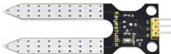
Este es un sensor de humedad del suelo simple que tiene como objetivo detectar la humedad del suelo. Si el suelo carece de agua, el valor analógico emitido por el sensor disminuirá; de lo contrario, aumentará. Si usa este sensor para hacer un dispositivo de riego automático, puede detectar si su botánica tiene sed para evitar que se marchite cuando salga. El uso del sensor con
