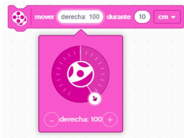
El giro de 100 o -100 es una rotación sobre el eje del robot, es decir que durante el giro este no se desplaza, en porcentajes inferiores hay desplazamiento.
